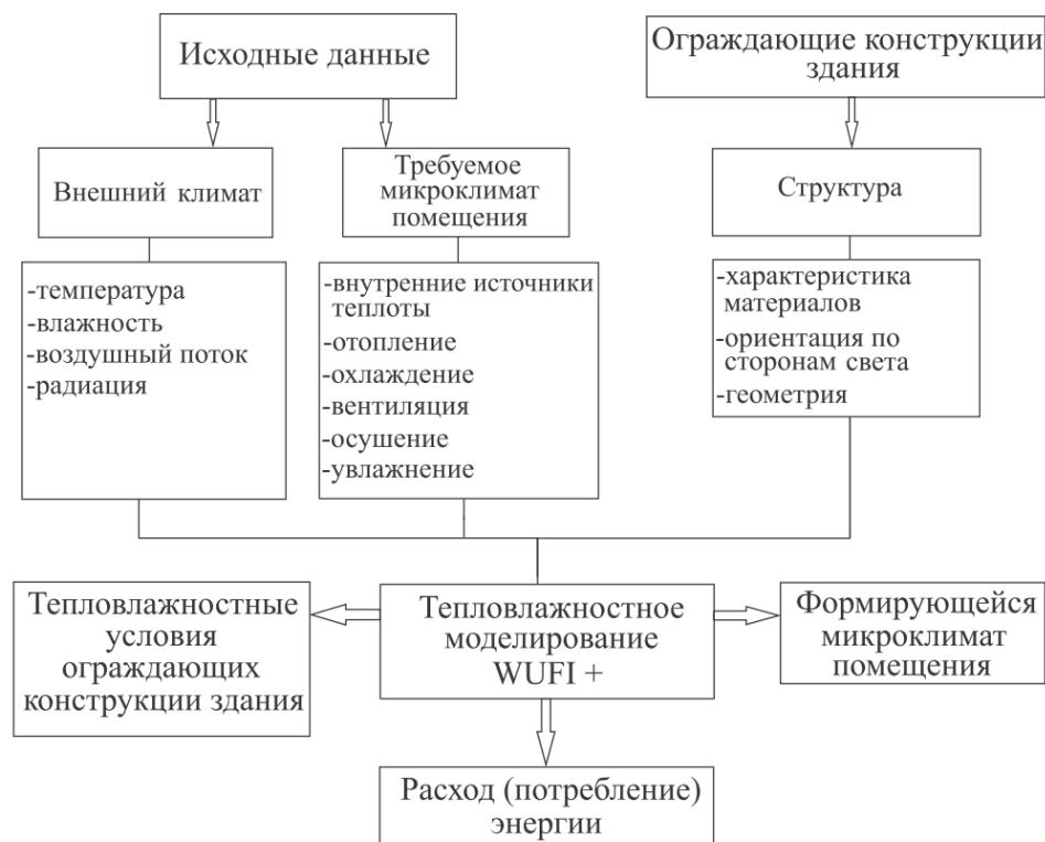
Рисунок 4.1 – Схема решения задачи с помощью программного обеспечения WUFI+ [136]
