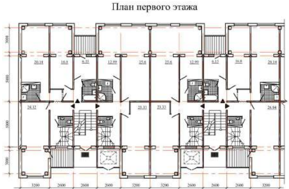
Рисунок 3.6 – Объемно-планировочное решение 1-го этажа жилого дома серии ТТЖ-1-464 после реконструкции
