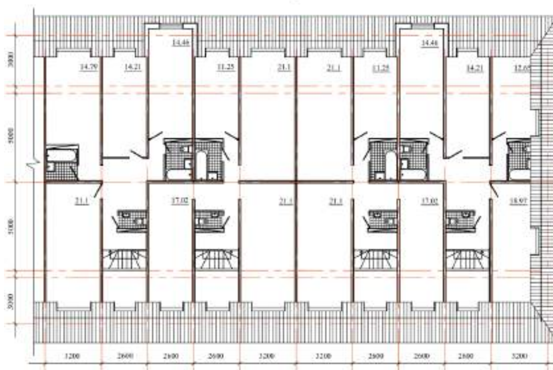
Рисунок 3.9 – Объемно-планировочное решение мансардного этажа жилого дома серии ТТЖ-1-464 после реконструкции
