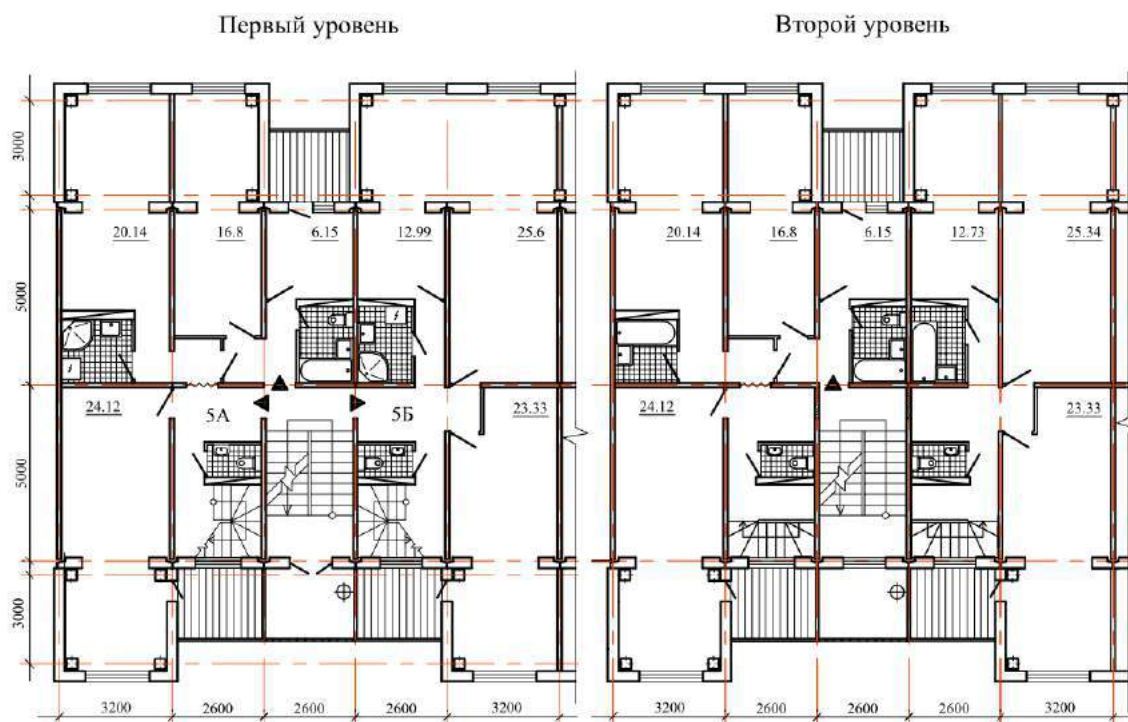
Рисунок 3.3 – План секции после реконструкции по варианту 2 с квартирой в двух уровнях
