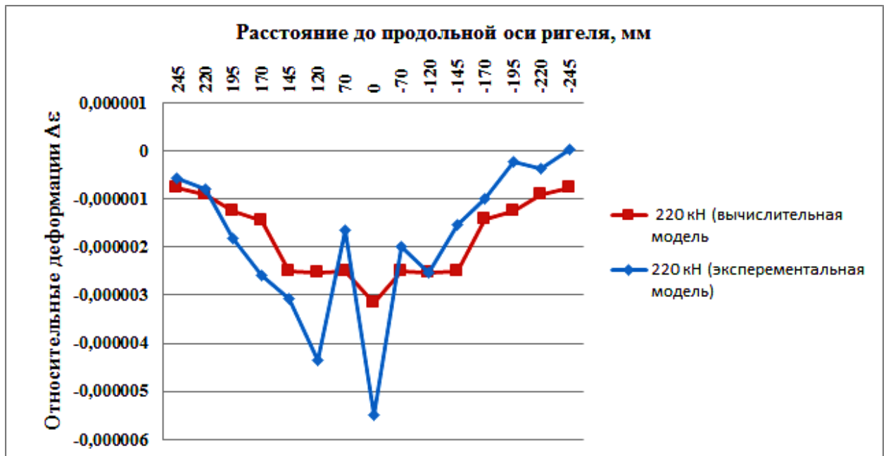
Рисунок 4.10 – Относительные деформации вдоль ригеля в зоне сопряжения с плитами экспериментальной и вычислительной моделей
