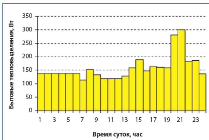
Рисунок 2.3 – Почасовые значения бытовых тепловыделений от жильцов в квартире жилого здания, Вт
