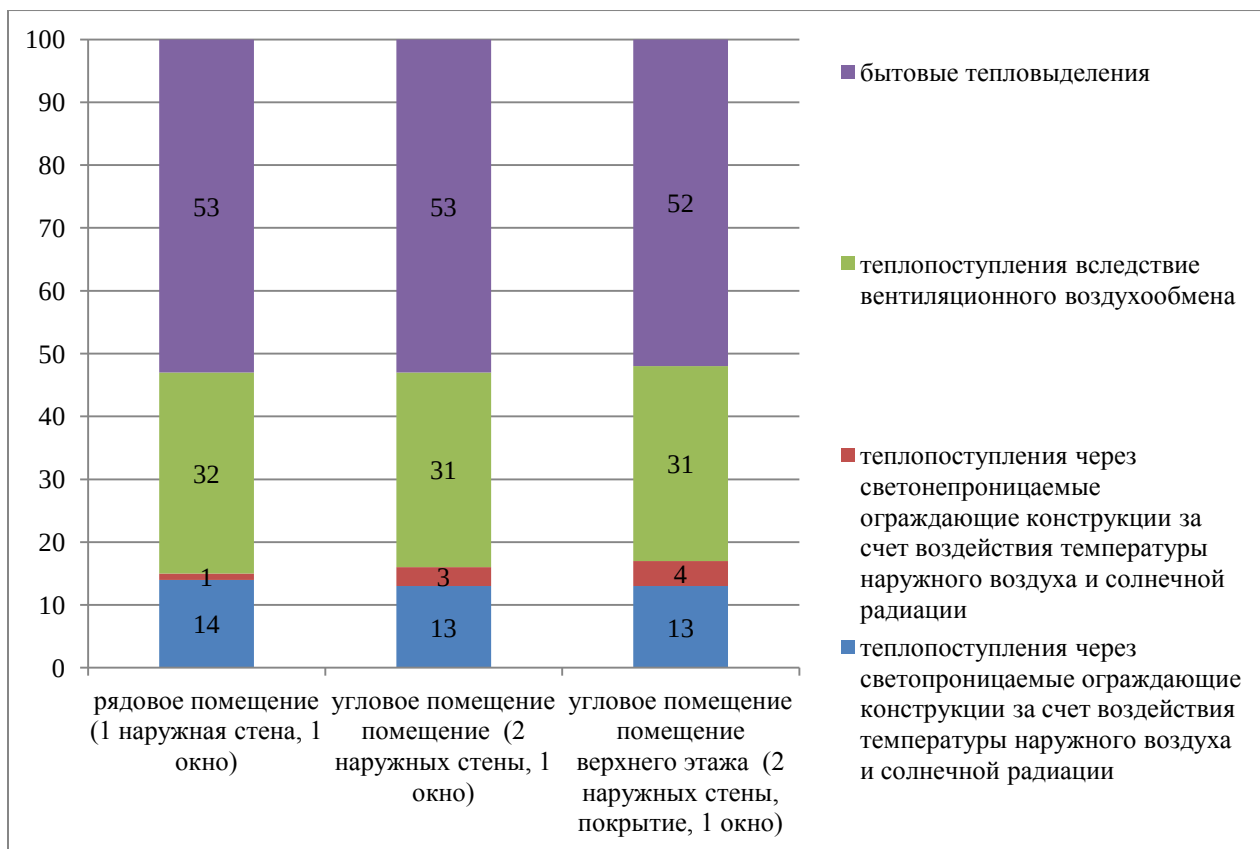
Рисунок 4.10 – Соотношение доли теплопоступлений через наружные светонепроницаемые и светопроницаемые ограждающие конструкции за счет воздействия температуры наружного воздуха и солнечной радиации, теплопоступлений вследствие вентиляционного воздухообмена и бытовых тепловыделений в общей структуре теплового баланса жилых помещений, %, для 13 июля.
