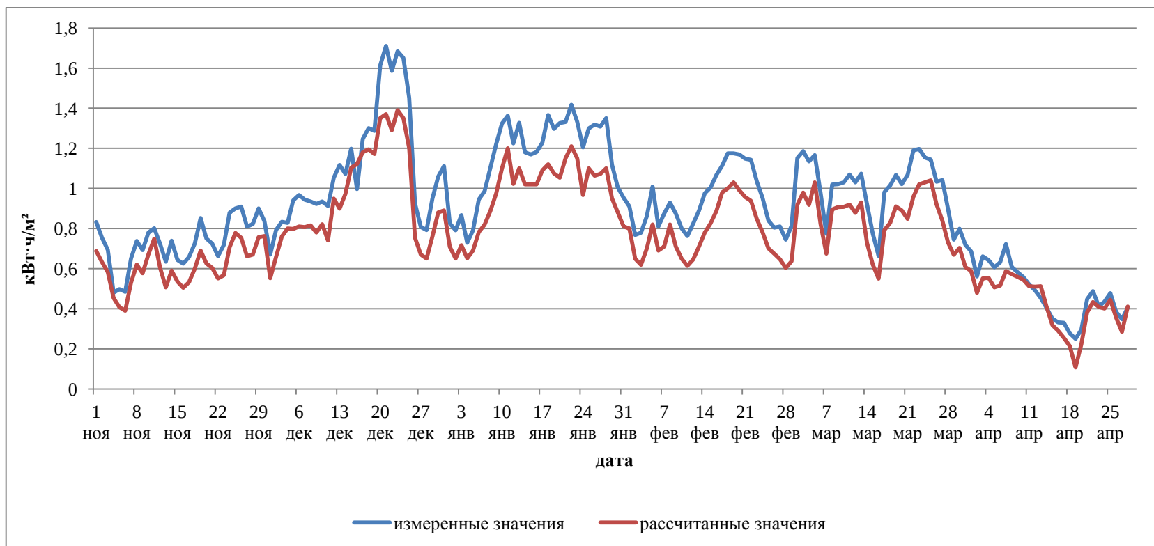
Рисунок 3.4 – Суточные изменения теплотребления на отопление жилой части многофункционального жилого комплекса, кВт·ч/м 2 , за временной период с 1 ноября 2012г. по 28 апреля 2013г.
