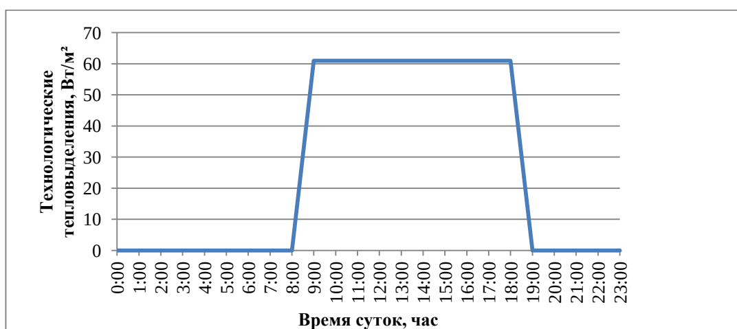
Рисунок 2.9 – График почасовых изменений величины технологических тепловыделений в офисном помещении в рабочие дни, Вт/м 2
