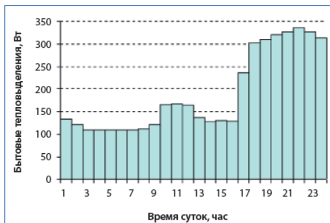
Рисунок 2.4 – Почасовые значения бытовых тепловыделений от используемой бытовой техники в квартире жилого здания, Вт
