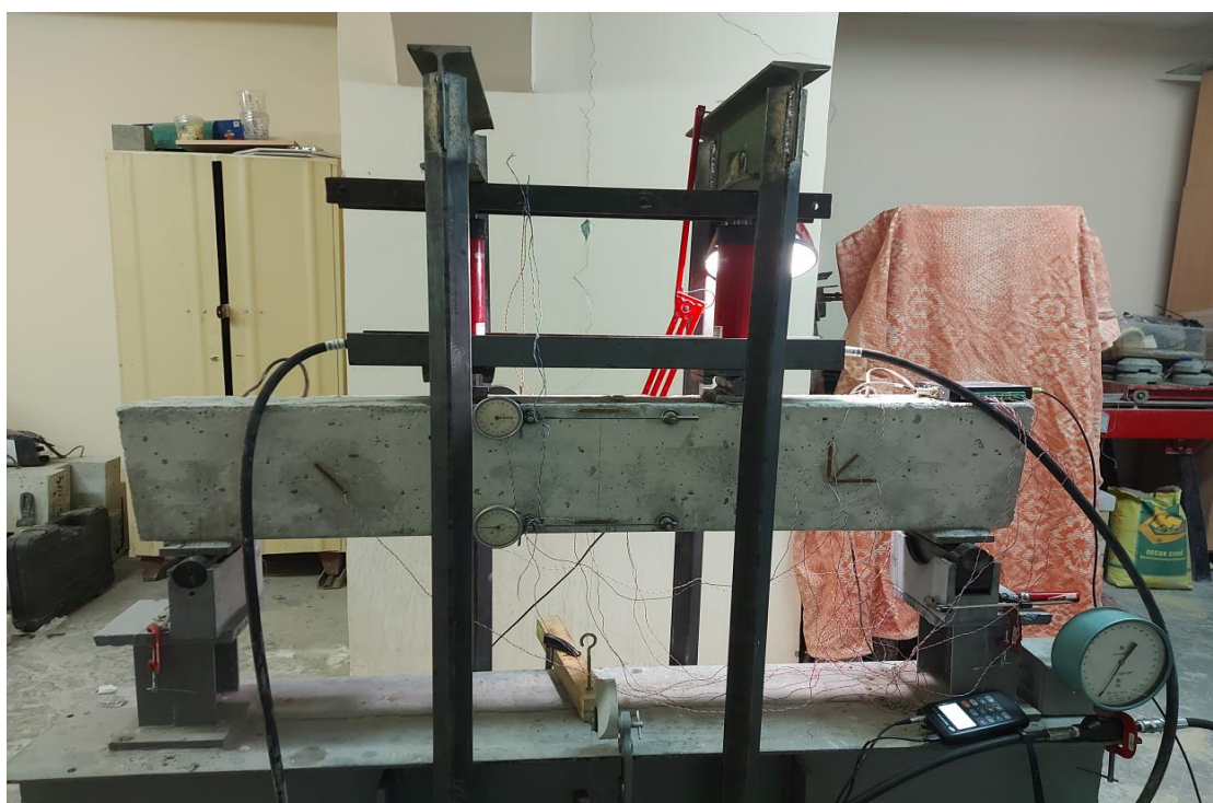
Рисунок 3.12 – Общий вид стенда для испытаний
