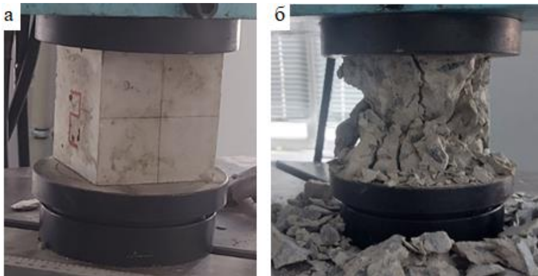
Рисунок 3.3 – Испытание кубов по прочности на сжатие: а – до испытания; б – после испытания
