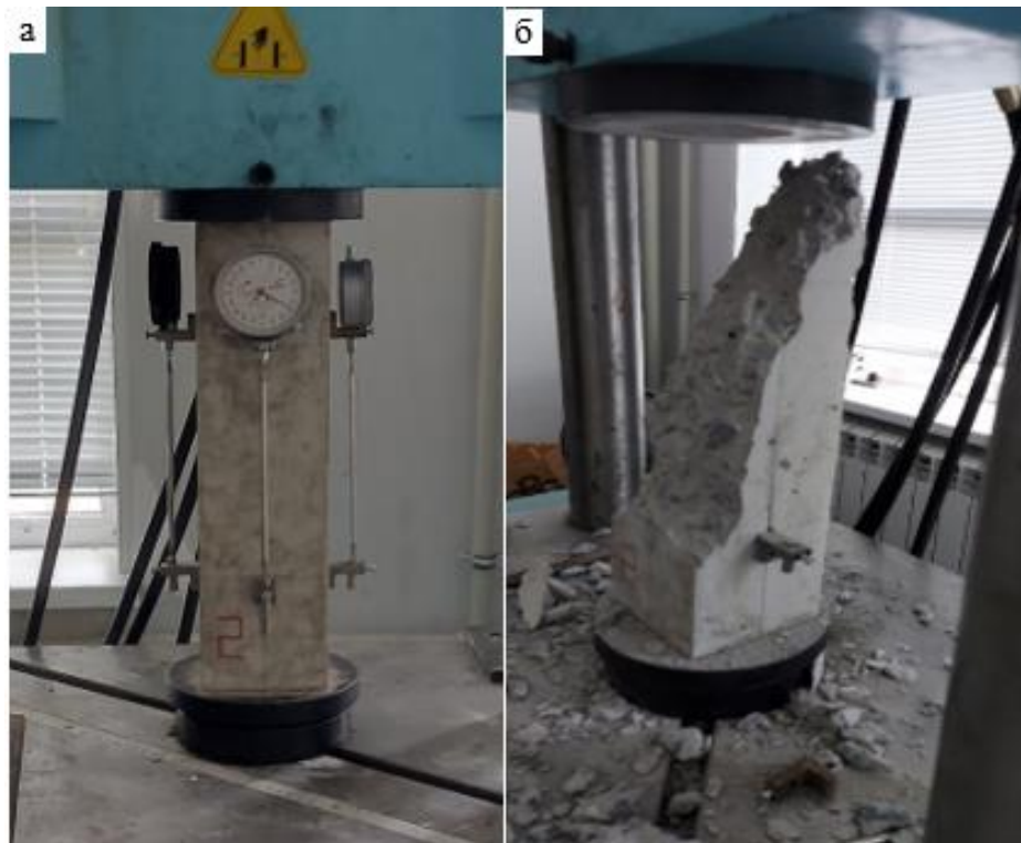
Рисунок 3.4 – Испытание призм по прочности на сжатие и определение модуля упругости: а – до испытания; б – после испытания
