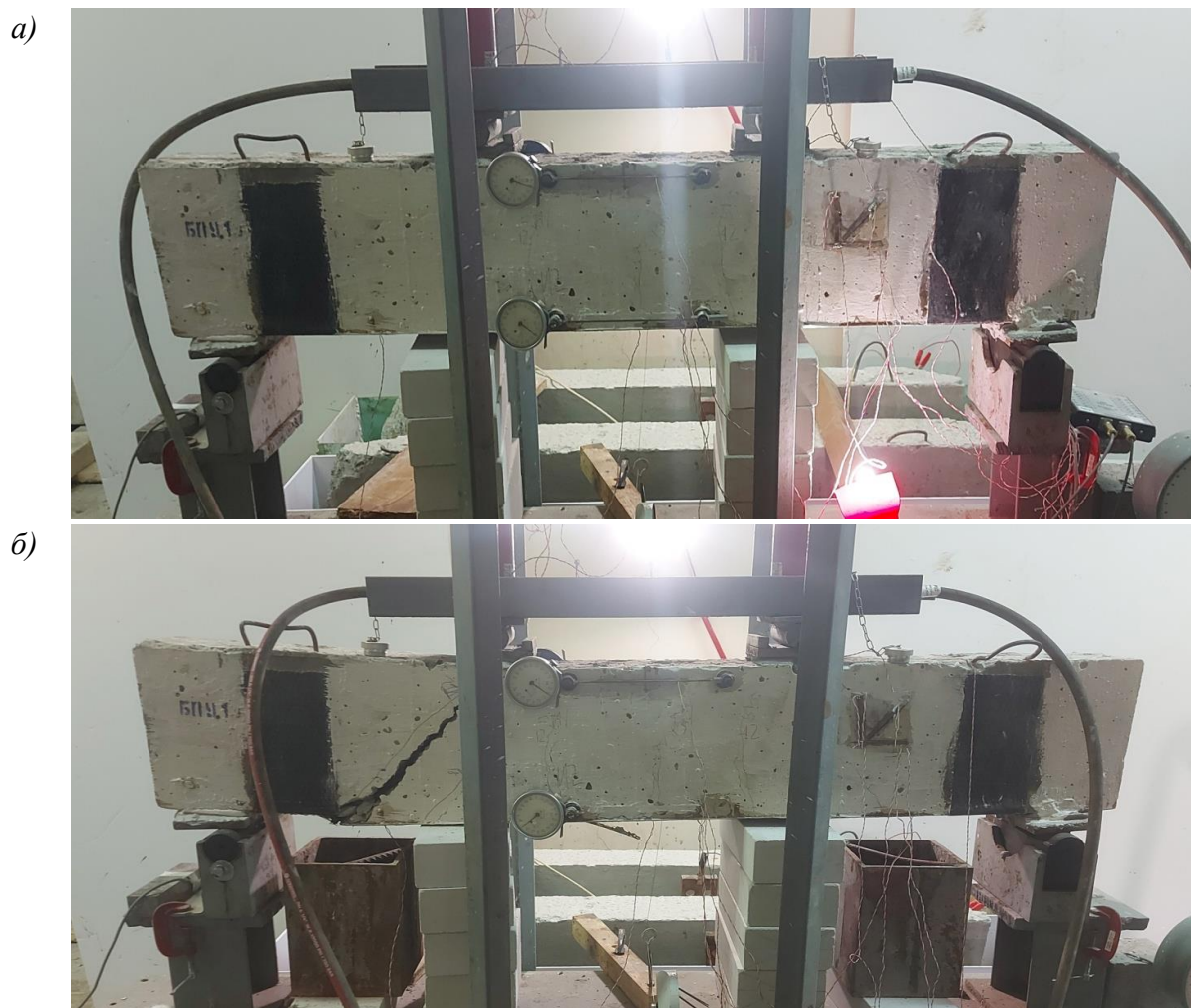
Рисунок 3.36 – Внешний вид контрольных образцов серии БПУ1: а – до испытания; б – на этапе предразрушения
