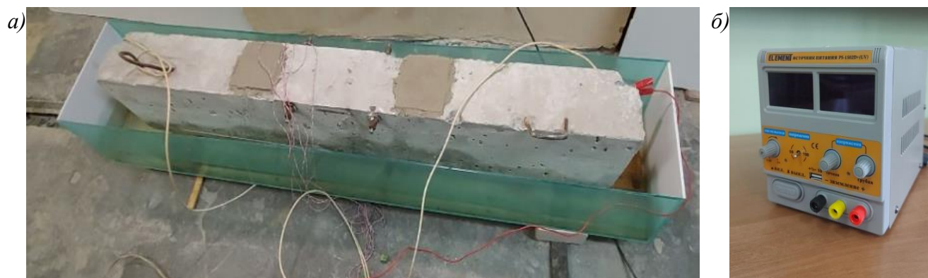
Рисунок 3.20 – Конструкция установки для проведения электрохимической коррозии: а – ванна; б – источник питания
