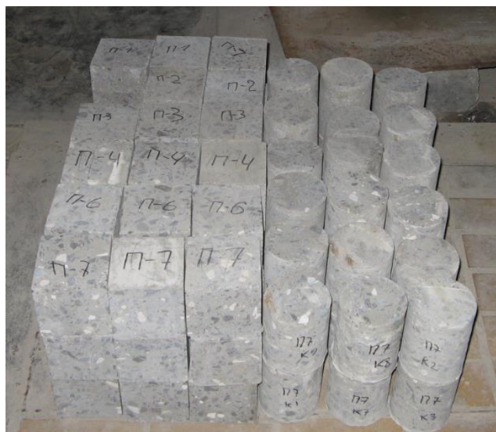
Рисунок 1.14 – Кубы и цилиндры, выпиленные из бортовых камней для исследования характеристик БТД
