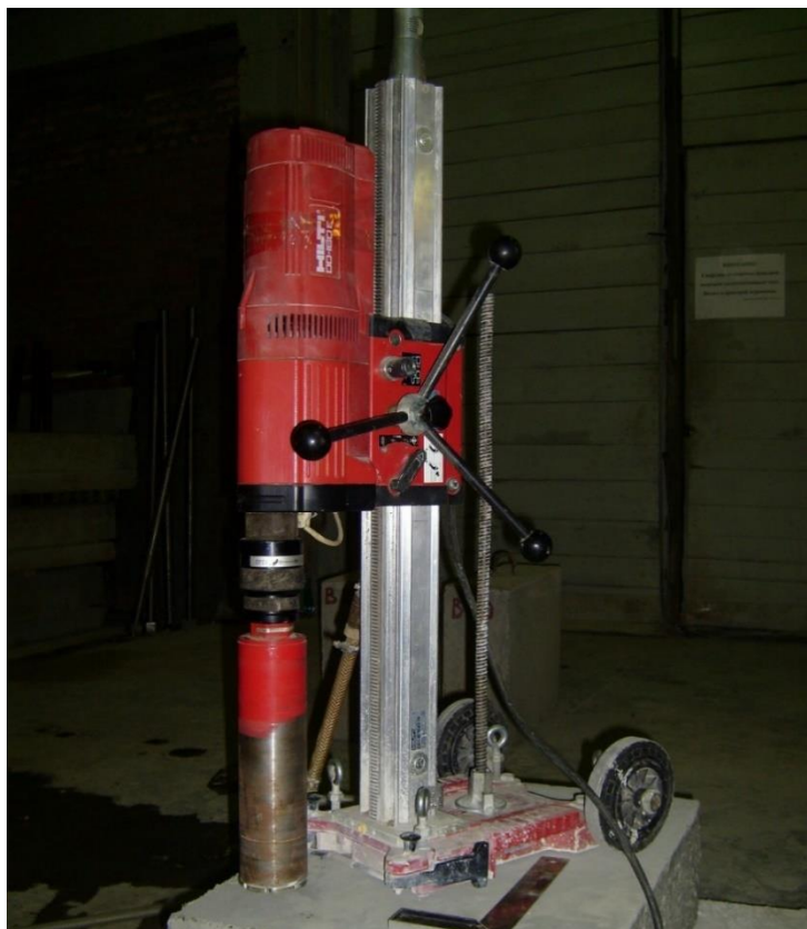
Рисунок 2.6 – Мини буровая установка HILTI с алмазной коронкой с внутренним диаметром 80 мм
