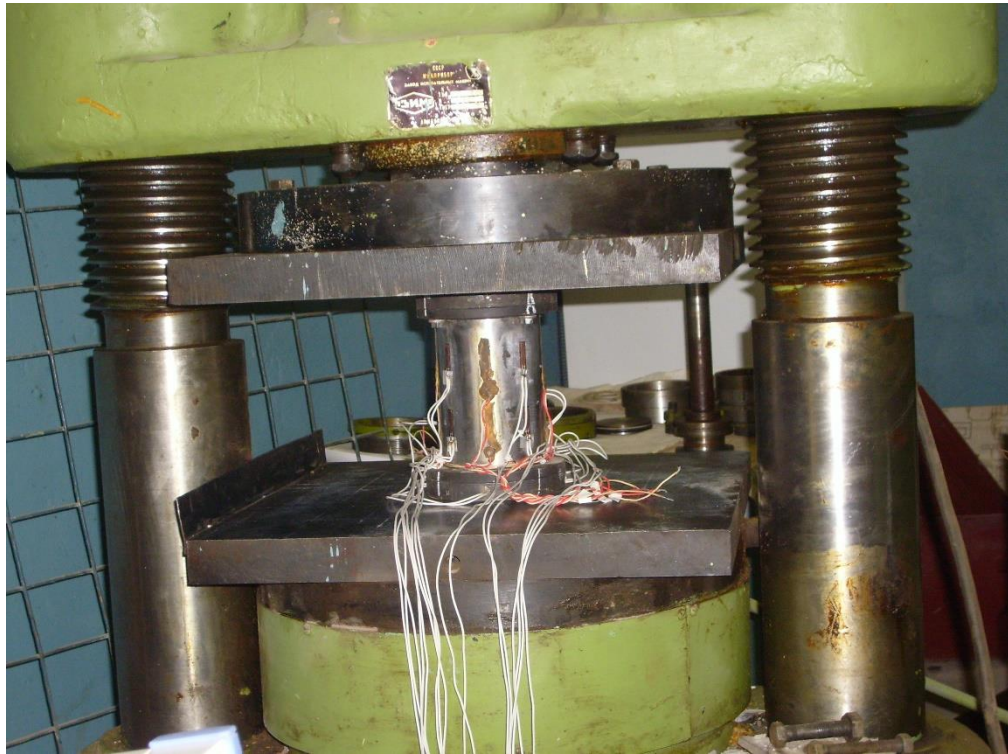
Рисунок 2.9 – Центрирование тензометрической трубы в прессе
