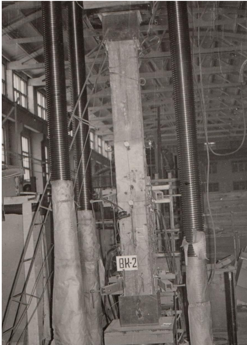
Рисунок 2.26 – Образец колонны из БТД в прессе НИИЖБ на 1000 тонн
