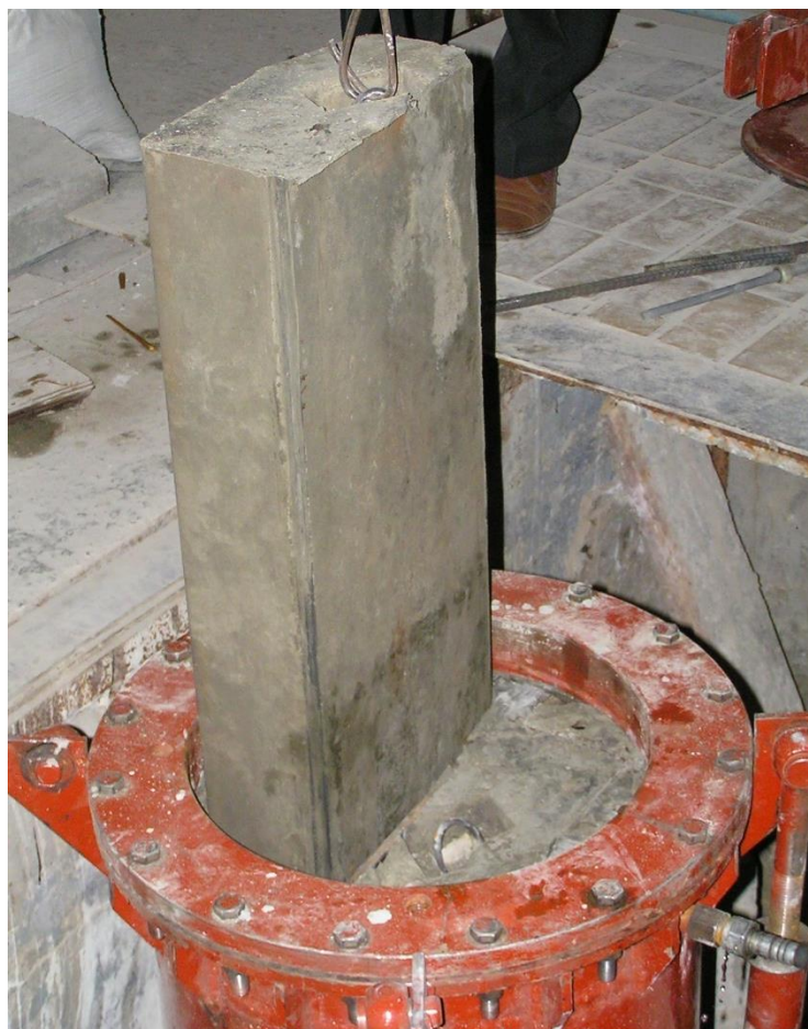
Рисунок 1.12 – Пресс-форма. Извлечение изготовленного бортового камня без разборки основной части пресс-формы
