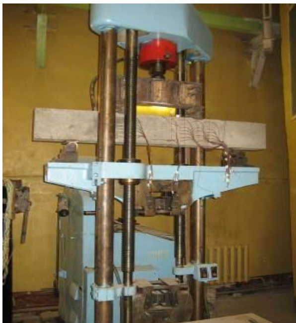
Рисунок 5.2 – Гидравлический пресс ГРМ1 с установленной балкой для испытания
