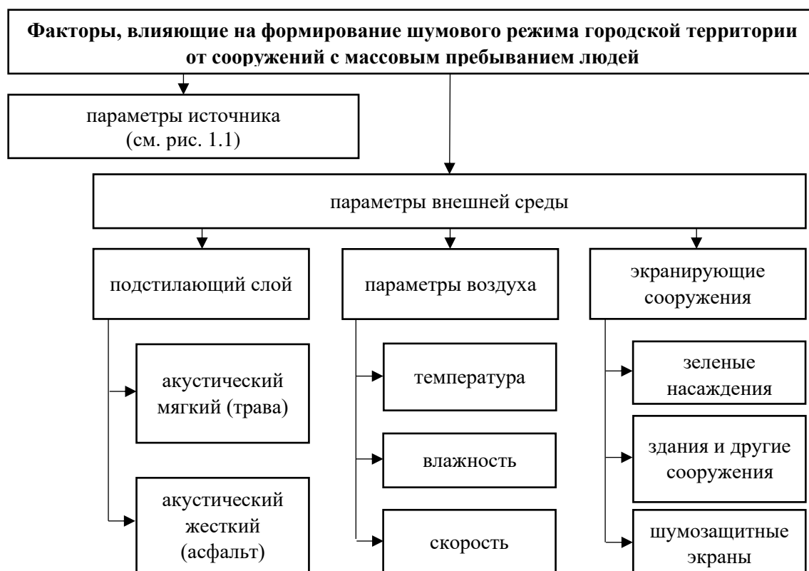
Рисунок 1.2 – Факторы, влияющие на распространение звука от сооружений с массовым пребыванием людей в пространстве городской застройки
