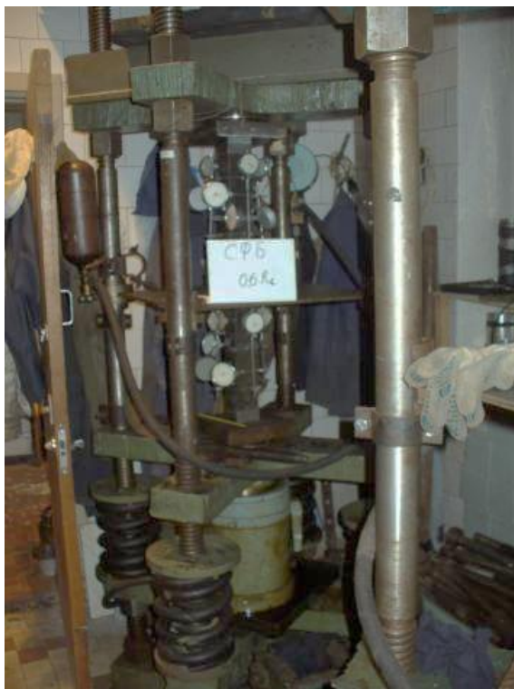
Рисунок 2.9 - Определение деформаций ползучести ВСФБ при уровне напряжений 0,6R_b [78]
