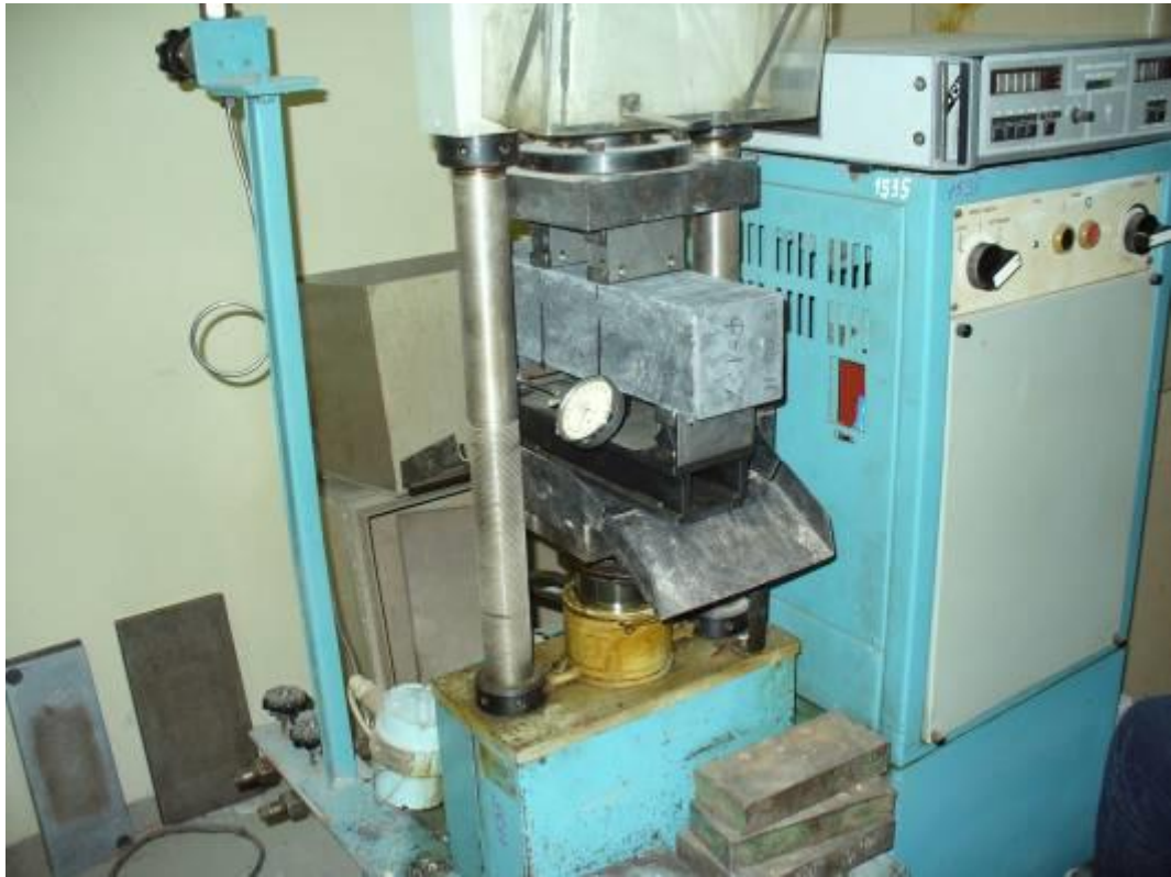
Рисунок 2.3 - Испытание бетонного образца на растяжение при изгибе [78]
