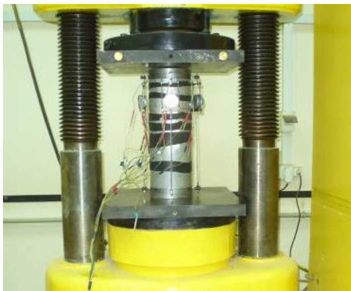
Рисунок 2.7 - Устройство для определения предельных деформаций МВБ и ВСФБ при сжатии [34]
