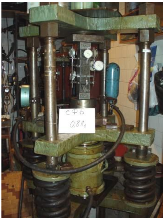
Рисунок 2.10 - Определение деформаций ползучести ВСФБ при уровне напряжений 0,8R_b [78]
