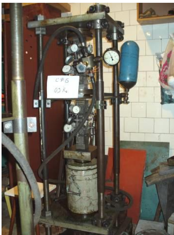
Рисунок 2.8 - Определение деформаций ползучести ВСФБ при уровне напряжений 0,3R_b
