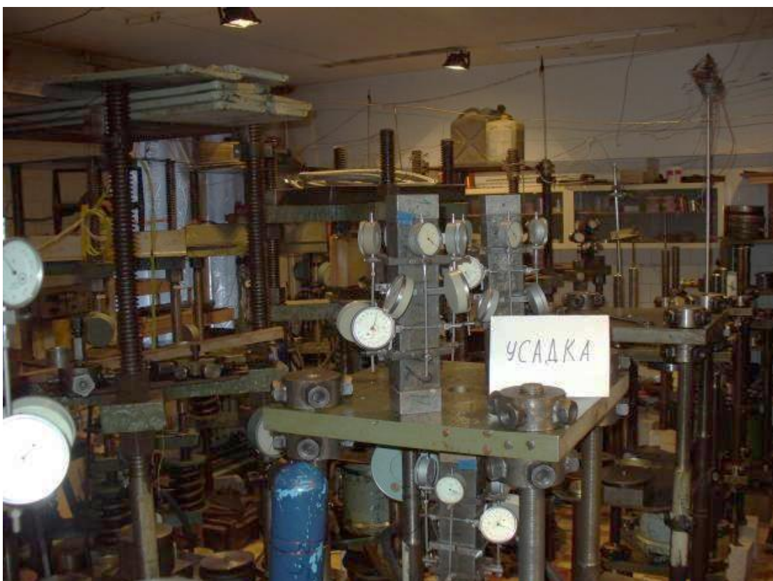
Рисунок 2.11 - Определение деформаций усадки ВСФБ [78]
