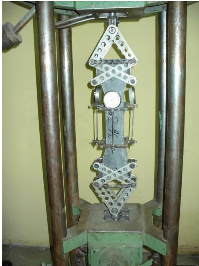
Рисунок 2.2 - Испытание бетонного образца на осевое растяжение [78]
