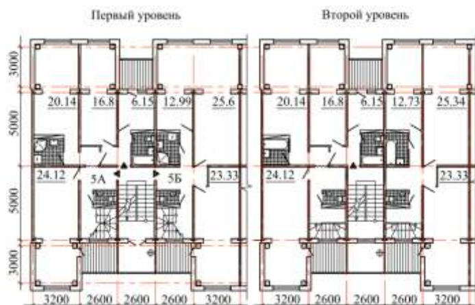
Рис.5 План секции после реконструкции жилого дома серии ТТЖ-1-464 в двух уровнях
